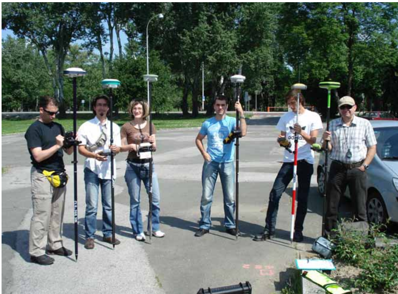
SLIKA 1. Testirani su instrumenti (s lijeva na desno): Magellan ProMark500, Sokkia GSR2700isx, Leica GPS1200, Trimble R8, Topcon Hiper+ i Javad Triumph-1-G3T.
